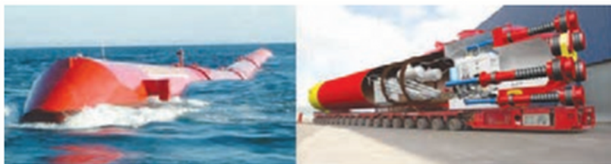
شکل ۸. این دستگاه دراز توربینی است که برای بهره‌برداری از انرژی موج‌های دریا ساخته شده است.
